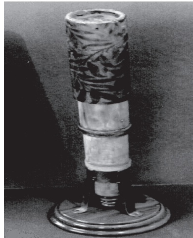
Figura 6. Microscopio compuesto creado por Eustaquio Divini, 1668, Bologna, Italia (30 cm.). El original se encuentra en el Museo Copernicana de Roma. Está construido con tubos de cartón telescopados. En la porción superior presenta un juego de dos lentes enfrentadas por la convexidad y en la porción inferior contiene una lente montada en madera. El sistema se ampara en un trípode de metal. (Fuente: sitio público de internet)
