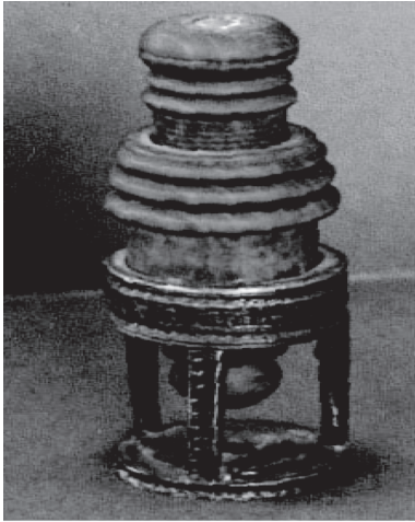
Figura 6. Microscopio compuesto creado por Eustaquio Divini, 1668, Bologna, Italia (30 cm.). El original se encuentra en el Museo Copernicana de Roma. Está construido con tubos de cartón telescopados. En la porción superior presenta un juego de dos lentes enfrentadas por la convexidad y en la porción inferior contiene una lente montada en madera. El sistema se ampara en un trípode de metal. (Fuente: sitio público de internet)
