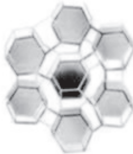
Figura 19. Estructura del hielo. Representación del arreglo cristalino del agua en estado sólido. (Fuente: sitio público de Internet)
