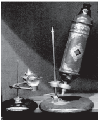
Figura 7. Microscopio compuesto construido por Christopher Cock, según diseño de Robert Hooke en 1670, Inglaterra (50 cm). (Fuente: sitio público de internet)
